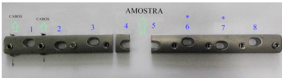
Figura 2 - Placa fraturada com o furos identificados e amostra já cortada para análise da superfície de fratura e outras propriedades. Os furos 6 e 7 apresentaram marcas de deformação internas. Pedacos do cabo usado para a colocação da prótese ainda estavam na placa e estão identificados na imagem.
